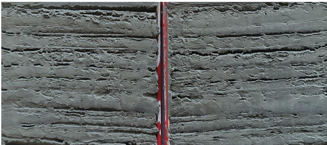
Figur 1 Borrpunkten, 24B003, 2,8 m. Jordprovet i nedre delen av överhylsan delad longitudinellt. Provhylsan med id Bjerking 1360.
