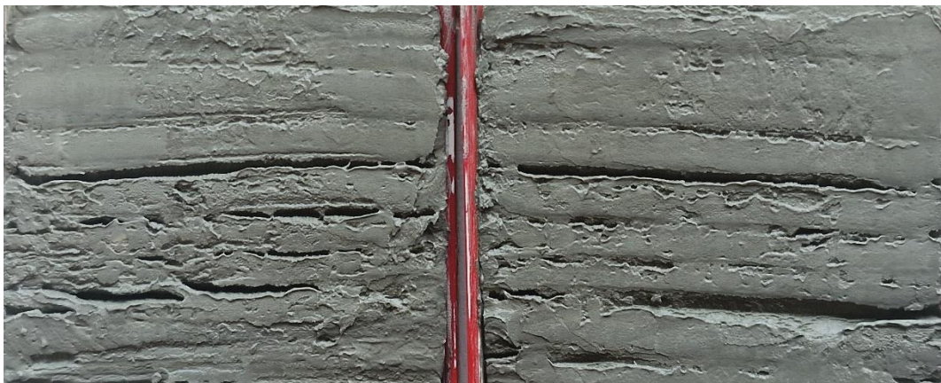
Figur 4 Borrpunkten, 24B006, 4,0 m. Jordprovet i nedre delen av mellanhylsan delad longitudinellt. Provhylsan med id Bjerking 1523.
